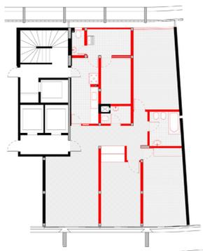
Planta de demolição
